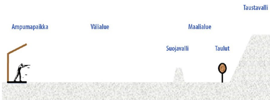
Kuva 1. Kivääri- ja pistooliradan rakenteita (Ympäristöministeriö 2023, 17).
